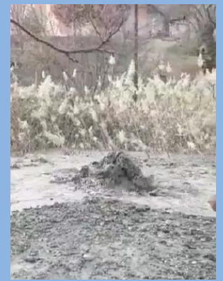
Dôme de vase en surface formé par la liquéfaction du sol – Séisme ELAZIG, Turquie 01-2020
